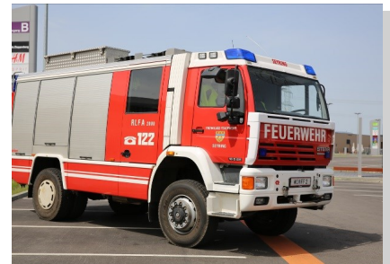
RLFA 2000—Rüstlöschfahrzeug Allrad mit 2000l Wassertank
